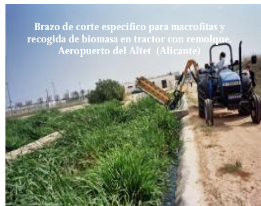
Detalle de recogida de biomasa y vertido en remolque de tractor, Aeropuerto del Altet (Alicante)
